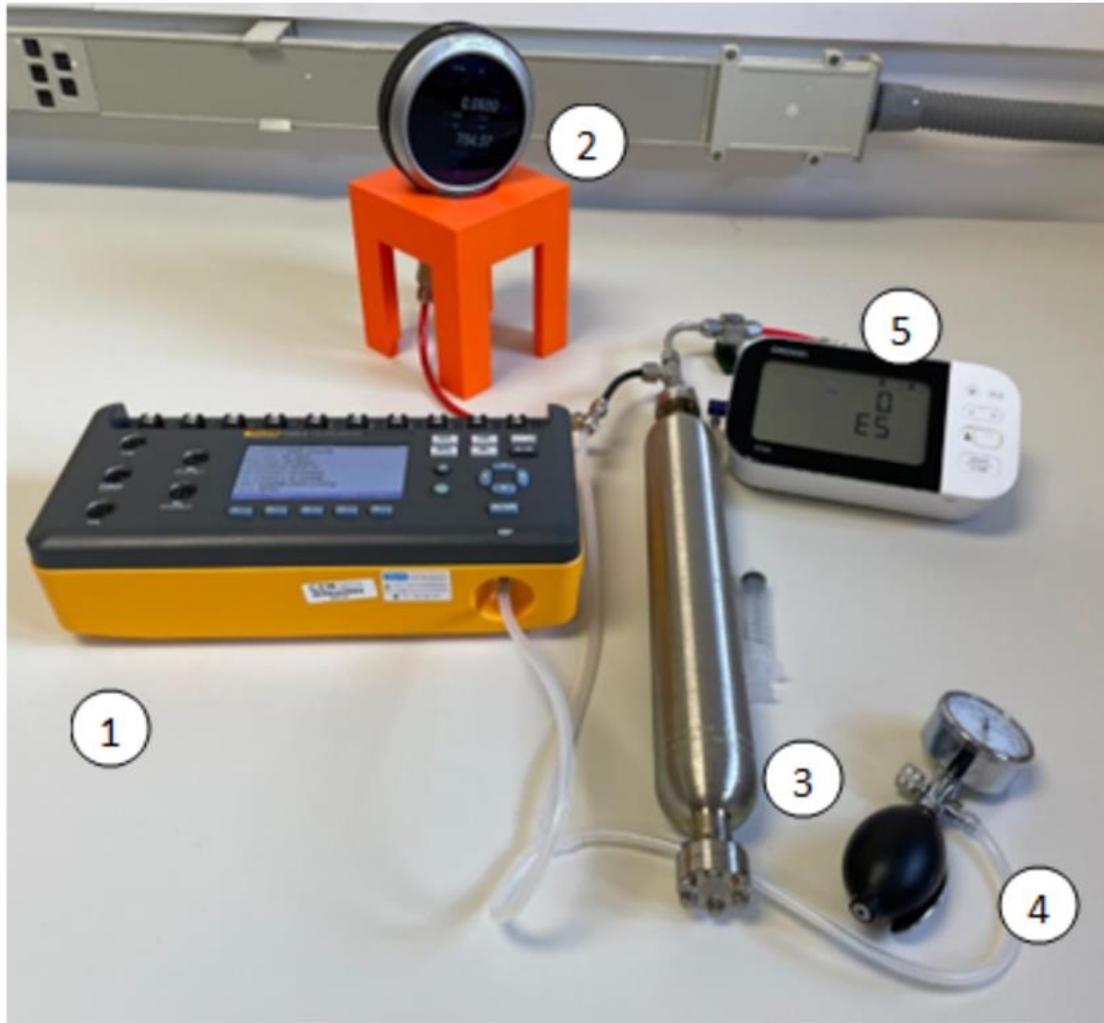
Figura 7. Instalación empleada durante uno de los ensayos del proyecto de tensiómetros en el Laboratorio de Salud del CEM. Toda toma de datos fue precedida de una prueba de fuga comandada por el simulador. Se comprobó que la pérdida de aire no superaba el valor recomendado por la Organización Internacional de Metrología Legal (OIML), en la OIML R 149-1 de 0,8 kPa/min [18].
